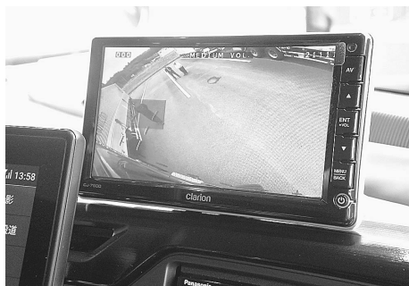
車載のモニターで死角に入った歩行者や自転車を検知。ドライバーの視野を拡張してくれる
